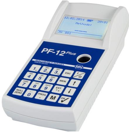
Für die mobile Analytik maßgeschneidertes Kompaktphotometer für NANOCOLOR® Rundküvettenteste und VISOCOLOR®-Teste.
