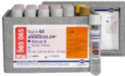
Nicht geeignet für die Meerwasseranalytik. Nitrat-Ionen reagieren in saurer Lösung mit 2,6-Dimethylphenol zu 4-Nitro-2,6-dimethylphenol, das photometrisch auswertbar ist. Reaktionsgrundlage analog zu DIN 38405-D9-2.
