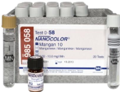
Messbereiche 0,1–10,0 mg/l Mn, bei Verwendung von Halbmikroküvetten 50 mm: 0,02–2,00 mg/l Mn.
