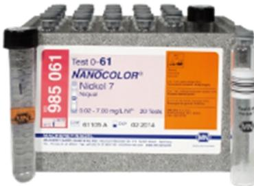
Messbereiche 0,10–7,00 mg/l Ni<sup>2+</sup>, bei Verwendung von Halbmikroküvetten 50 mm: 0,02–1,00 mg/l Ni<sup>2+</sup>.
