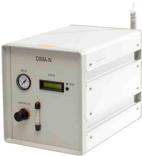
Der DIMA-N ist ein Erweiterungsmodul für DIMATOC TOC-Analysatoren.
