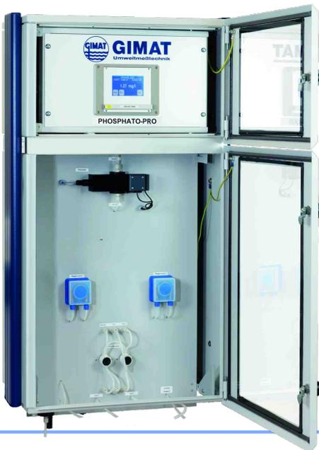
Die PHOSPHATO-Serie bietet Online-Analysatoren zur kontinuierlichen Überwachung der ortho-Phosphatkonzentration in Messbereichen von bis zu 50 mg/l  $\text{PO}_4\text{-P}$ .
