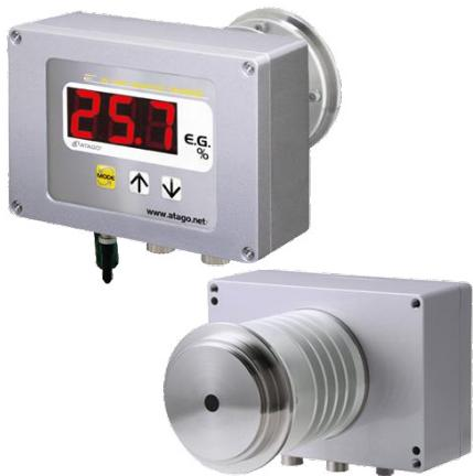
Das CM-800 $\alpha$  EG ist ein leistungsfähiges Inline-Refraktometer mit hoher Genauigkeit, großem Messbereich und attraktivem Preis-Leistungsverhältnis. Diese Version ist programmiert mit der Skala für Ethylenglykol und bestimmt die Ethylenglyolkonzentration sowie den Gefrierpunkt. Für die Echtzeit-Überwachung von Kühlmittel, Gefrierschutz- und Enteisungsmittel.
