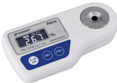
Digitales Refraktometer für schnelle und einfache Brix-Messungen an verschiedensten Flüssigkeiten, wie Nahrungsmittel (z. B. Fruchtsäfte, Getränke) als auch Industrieflüssigkeiten (z. B. Schneidöl, Reinigungsflüssigkeit, Frostschutzmittel). Eine Messung benötigt nur wenige Tropfen Probe und dauert nur 3 Sekunden.
