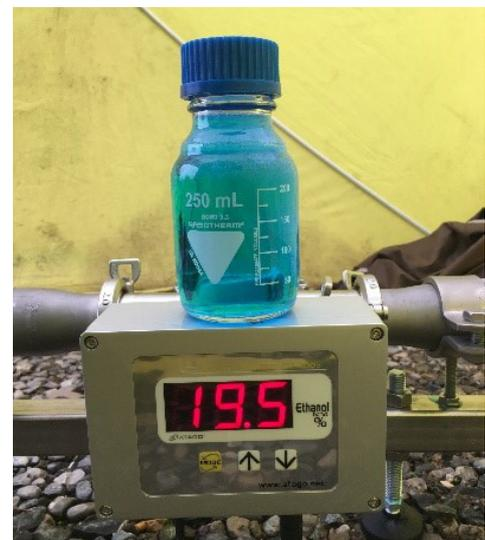
Inline-Refraktometer CM-800α für Ethanol
