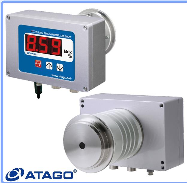
Das kompakte Kombigerät vereint Messaufnehmer und Messumformer mit Vor-Ort-Displayanzeige, SPS-Anschluss und PC-fähigem Anschluss kostengünstig in einer Einheit.
