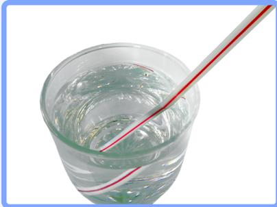
Wenn ein Strohhalm in ein Glas mit Wasser gestellt wird, erscheint der Strohhalm geknickt. Diese Erscheinung ist als Lichtbrechung bekannt. Befindet sich in dem Glas Zuckerwasser, so erscheint der Strohhalm stärker geknickt, als im anderen Glas mit reinem Wasser.
