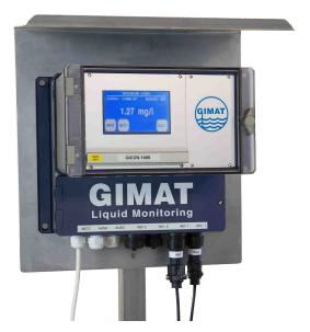
Der Messumformer für alle GIMAT-Messsonden. Die einfach gehaltene Menüführung und das Touchscreen-Display erleichtern die Einarbeitung und gestalten die Bedienung unkompliziert.
